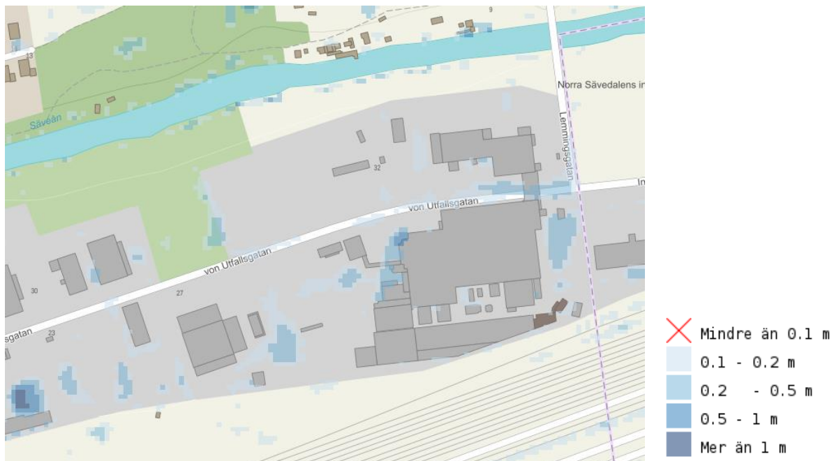
Befintlig översvämningssituation vid klimatanpassat 100-årsregn. Bild: stadsbyggnadsförvaltningen
