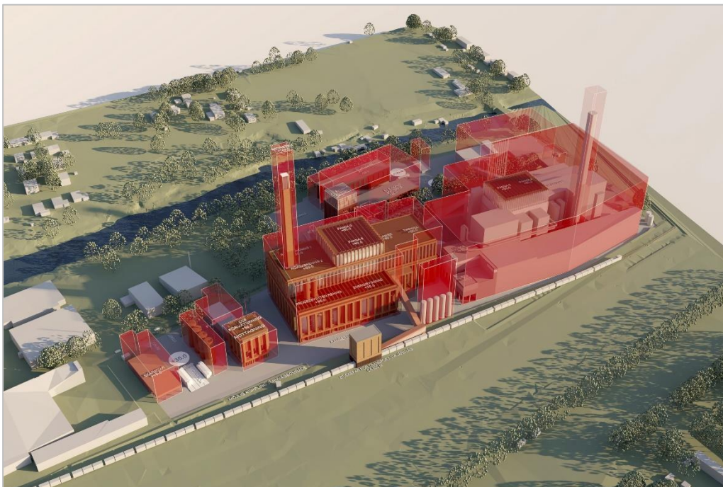
Modell visar detaljplanens maximalt utnyttjade byggrätt. Perspektiv sett från söder. Röd=planerad bebyggelse, röd transparent=maximalt utnyttjad byggrätt, blå/grå=befintlig bebyggelse. Bild: Liljewall
